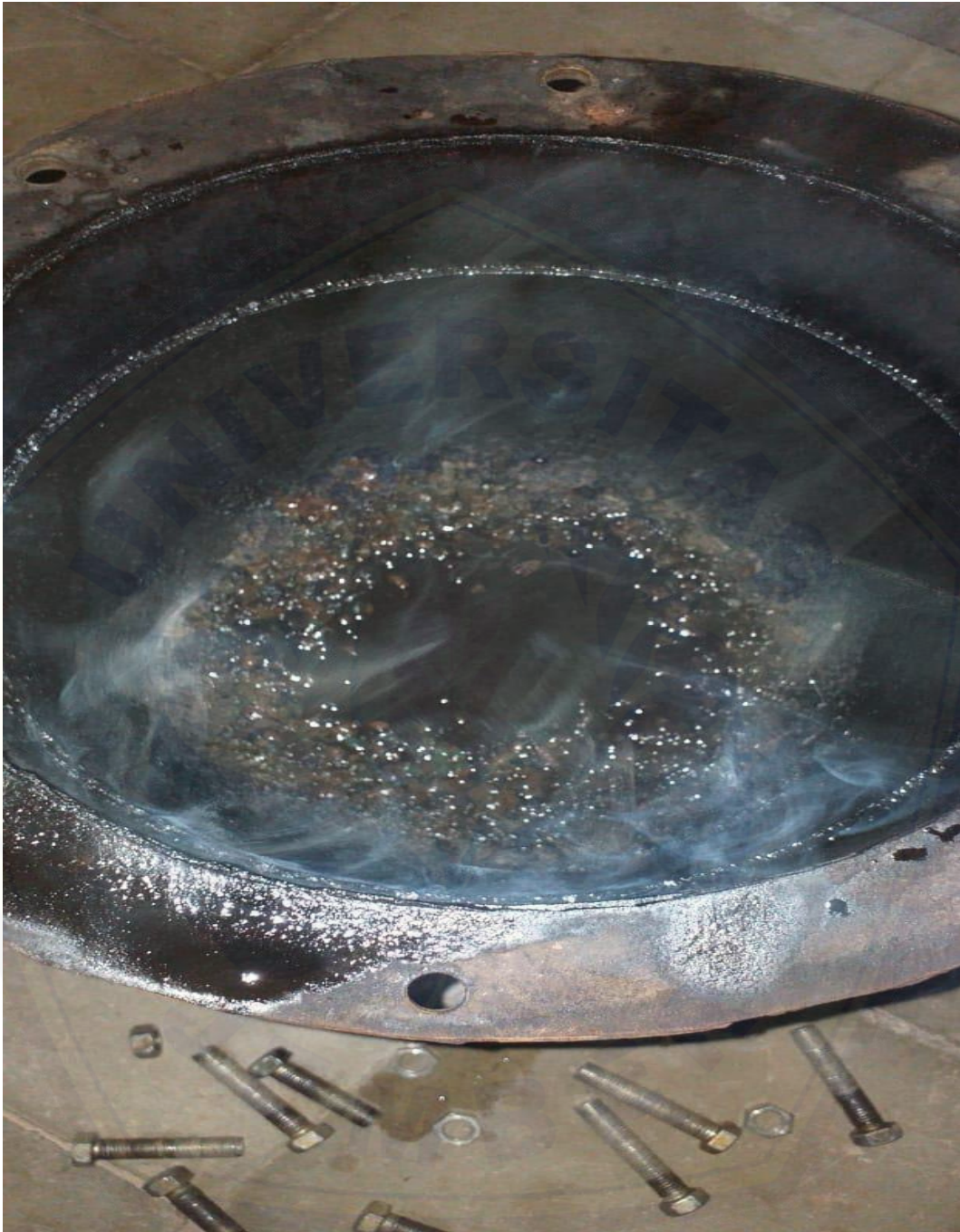
Gambar B. 4 Hasil sisa proses pirolisis (Arang), Plastik LDPE
