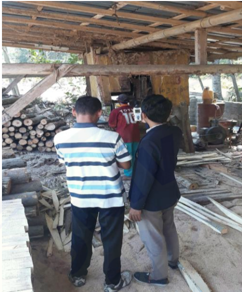
Gambar 1 Pengukuran Kebisingan di UD Sumber Harta
