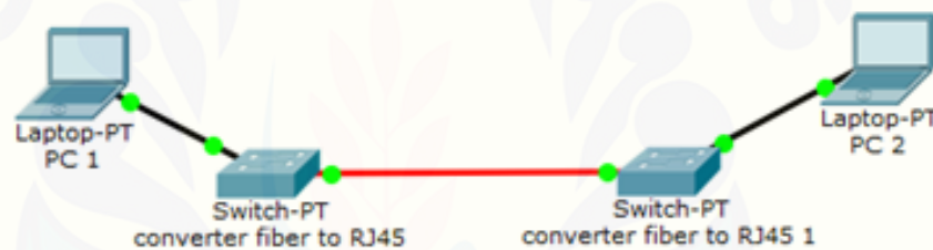
Gambar 3.2 konfigurasi pengambilan data
