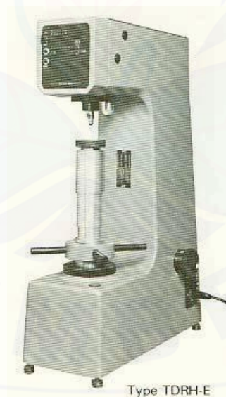
Gambar 2.11 Konstruksi alat uji kekerasan Rockwell (Sudjana, 2008)
