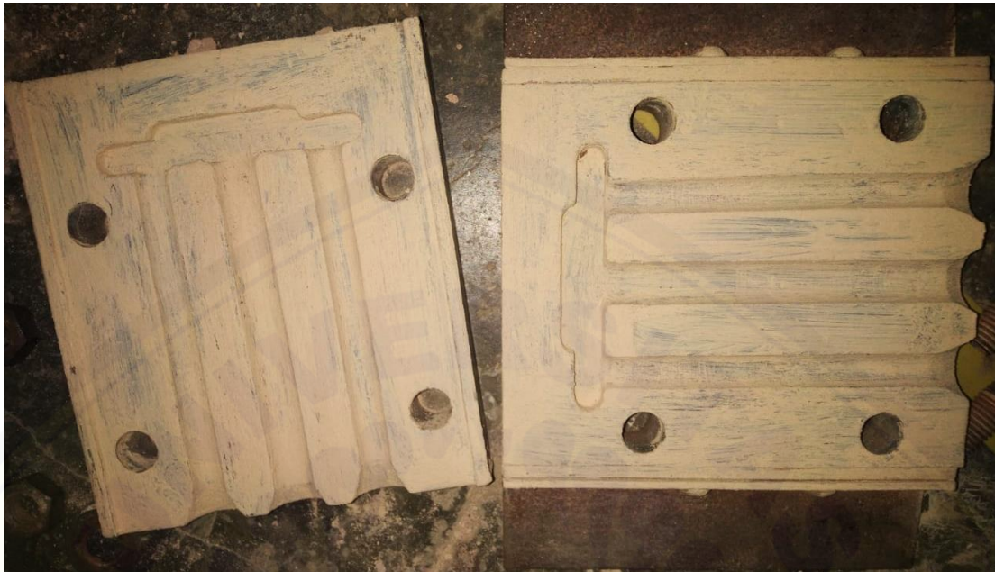
Cetakan yang telah dilapisi mortar
