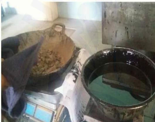
Gambar 15 Proses Pencampuran dengan Aspal.
