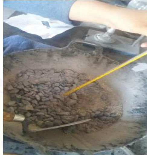
Gambar 14 Proses Pengukuran suhu optimal untuk pencampuran dengan aspal.
