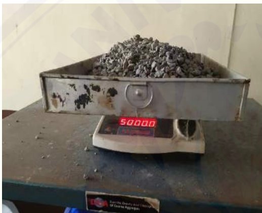
Gambar 3 Proses Persiapan agregat untuk pengujian berat jenis.
