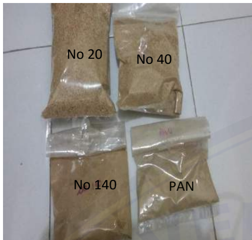
Gambar 7 Serat Tongkol Jagung setelah analisa saringan.
