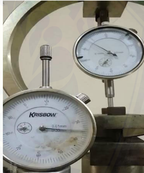
Gambar 21 Proses Pembacaan dial pengujian marshall.
