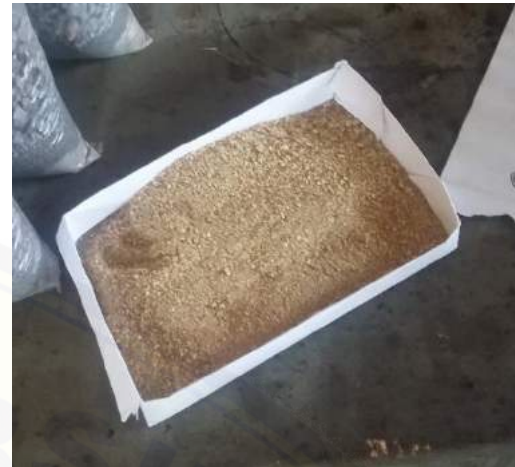
Gambar 8 Hasil Penggilingan Tongkol Jagung berupa serbuk.
