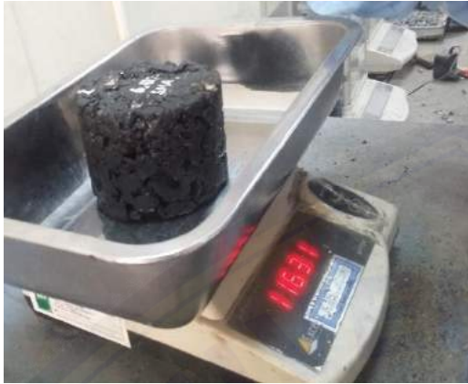
Gambar 18 Proses Pengujian volumetrik.
