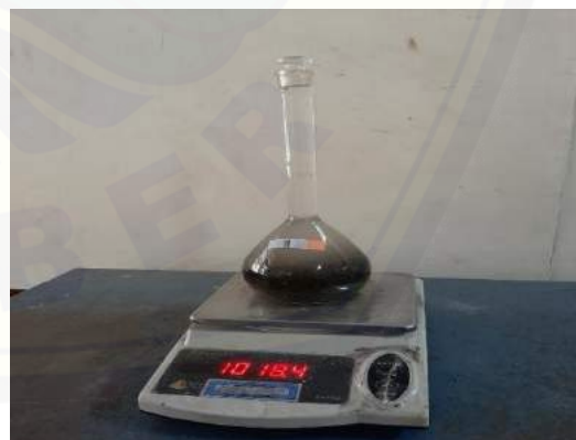
Gambar 6 Proses Pengujian Berat Jenis Agregat Halus
