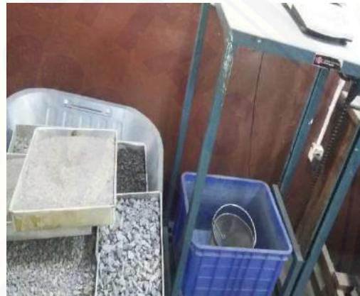
Gambar 4 Proses Pengujian Berat Jenis Agregat Kasar
