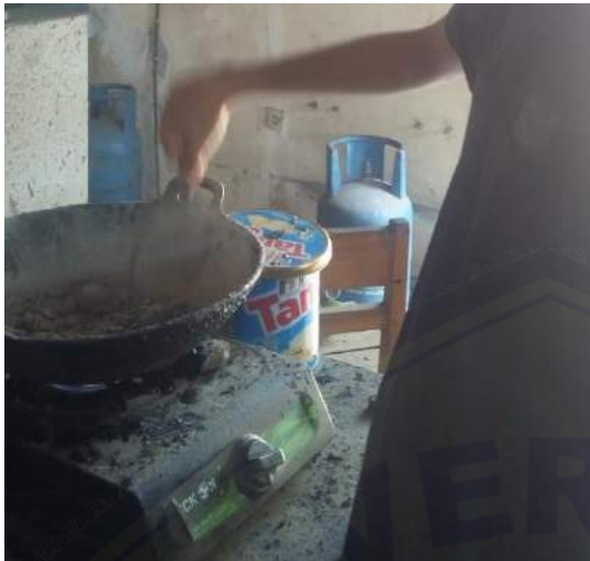
Gambar 13 Proses Pencampuran Agregat dan serat selulosa tongkol Jagung.
