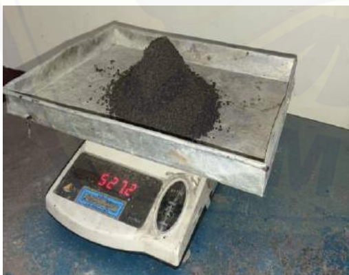
Gambar 5 Proses Persiapan agregat halus untuk pengujian berat jenis.
