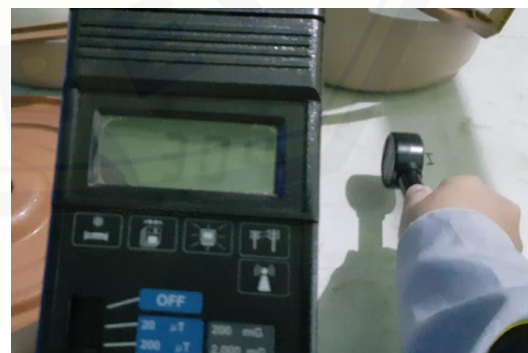
Gambar 2. Pemaparan medan magnet ELF pada sampel kopi green coffee yang difermentasi
