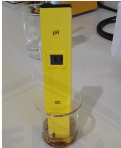
Gambar 3.5 pH meter ATC 190012 (Sumber: dokumen pribadi)
