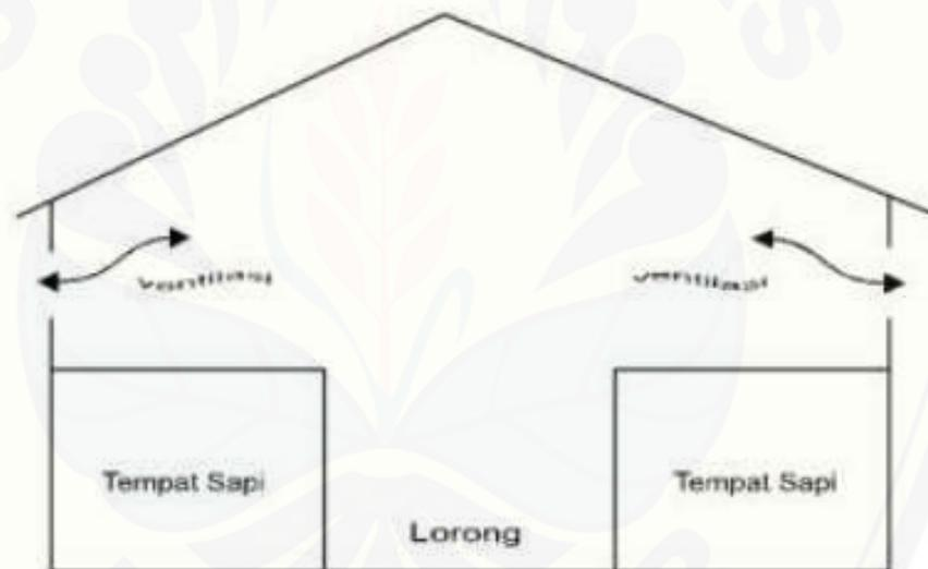
Gambar 2.25 contoh skema kandang sapi dengan ventilasi yang baik
