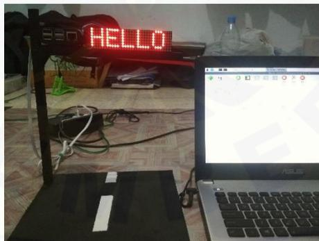
Gambar 3. 10 Pengujian running text dengan masukan “HELLO”
