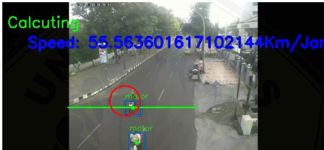
Gambar 1. Hasil *capture* gambar kendaraan pada kecepatan terdeteksi sebesar 55.56 Km/Jam
