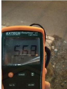
Gambar 3.9 Pengambilan nilai intensitas cahaya menggunakan luxmeter pada pukul 19.00 WIB
