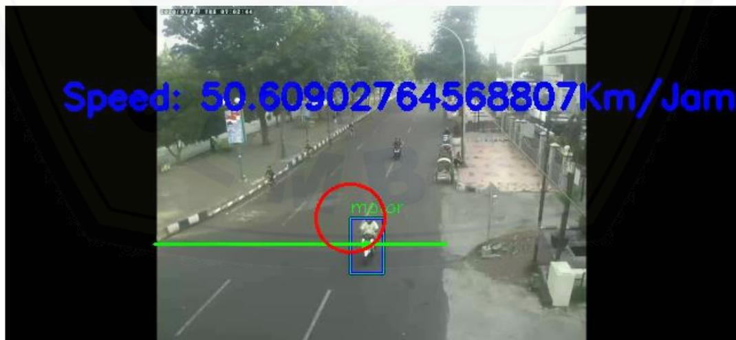
Gambar 2. Hasil *capture* gambar kendaraan pada kecepatan terdeteksi sebesar 50.6 Km/Jam
