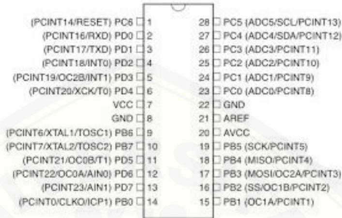
Gambar 2.4 Konfigurasi pin Atmega 328P
