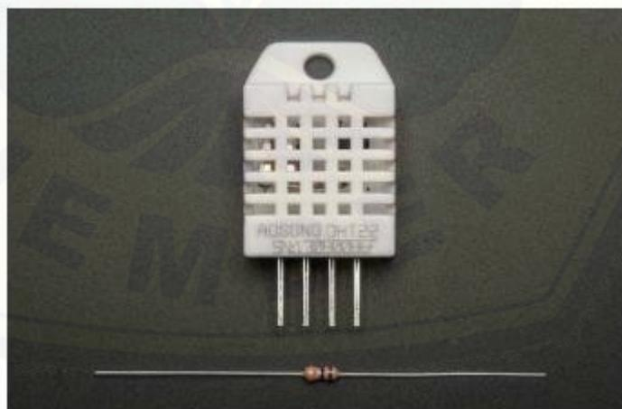
Gambar 2.1 Sensor DHT22
