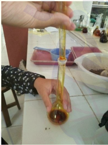
Menambah Larutan Pengestrak, mendinginkan larutan selama 30 menit, lalu diukur menggunakan kolorimeter pada panjang gelombang 693 nm
