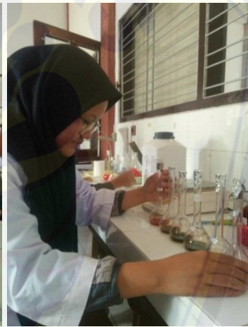
Menambah Larutan Pengestrak, mendinginkan larutan selama 30 menit, lalu diukur menggunakan kolorimeter pada panjang gelombang 693 nm
