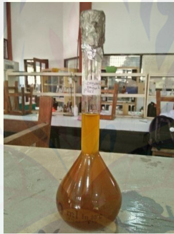
Menambah Larutan Pengestrak, mendinginkan larutan selama 30 menit, lalu diukur menggunakan kolorimeter pada panjang gelombang 693 nm
