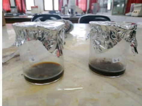
Gambar 3.4. Perendaman cakram resin komposit microhybrid dalam larutan kopi murni
