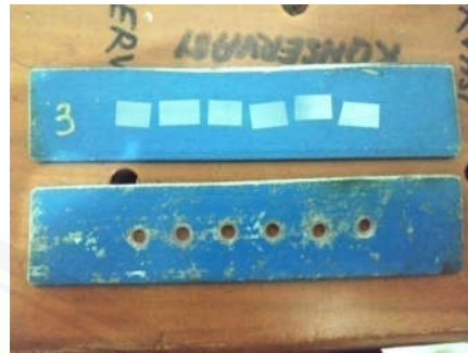
Pemasangan Celluloid strip dan syringe insulin pada cetakan
