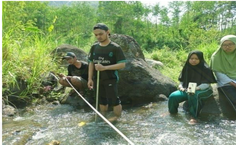
Gambar 3.3 Pengukuran debit sungai
