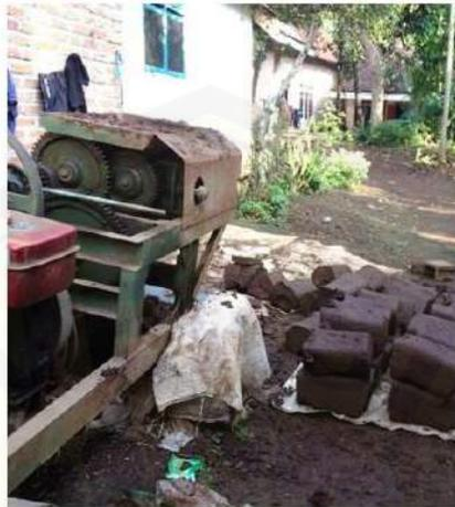
Gambar 3. Proses pembuatan lempung
