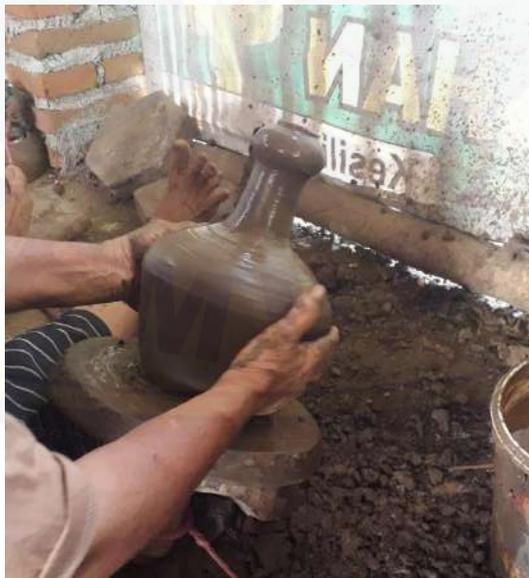
Gambar 2. 3 Proses pembentukan gerabah dengan teknik putar
