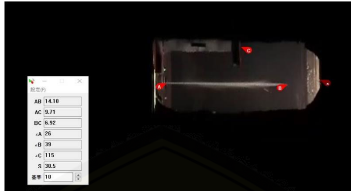
Gambar C.4 Pengukuran data spray tip penetration pada tekanan injeksi 15 MPa
