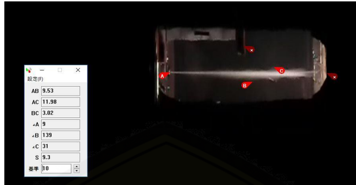
Gambar C.16 Pengukuran data spray angle pada tekanan injeksi 15 MPa
