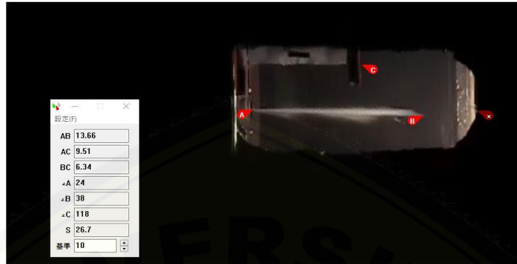
Gambar C.1 Pengukuran data spray tip penetration pada tekanan injeksi 15 MPa
