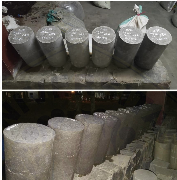
Gambar 27. Pengangkatan Benda Uji Setelah Curing
