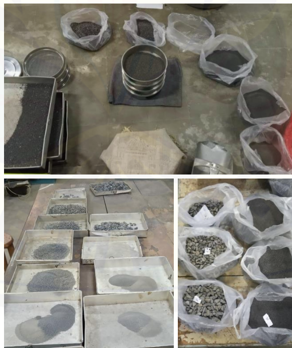
Gambar 8. Penyaringan Agregat Sesuai Klasifikasi Ukuran Agregat
