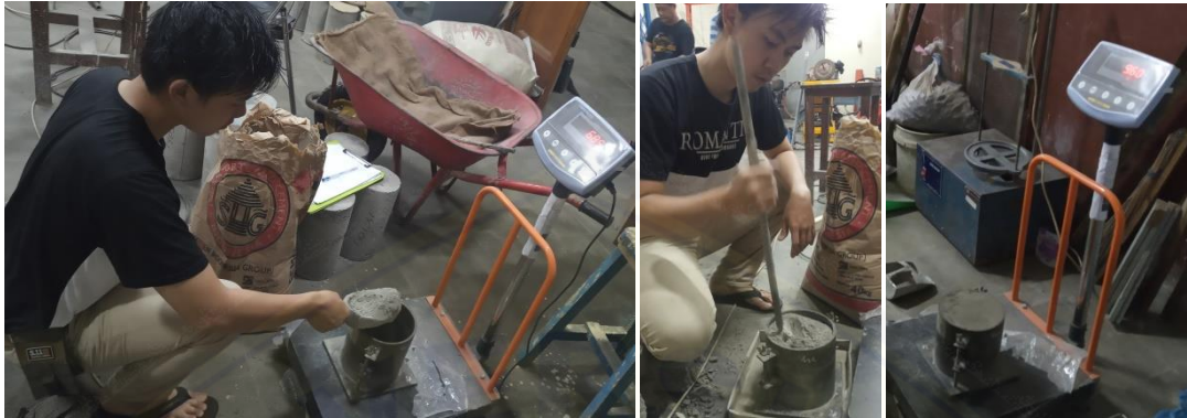
Gambar 12. Pengujian Berat Volume (Semen, Lusi, dan Fly Ash )
