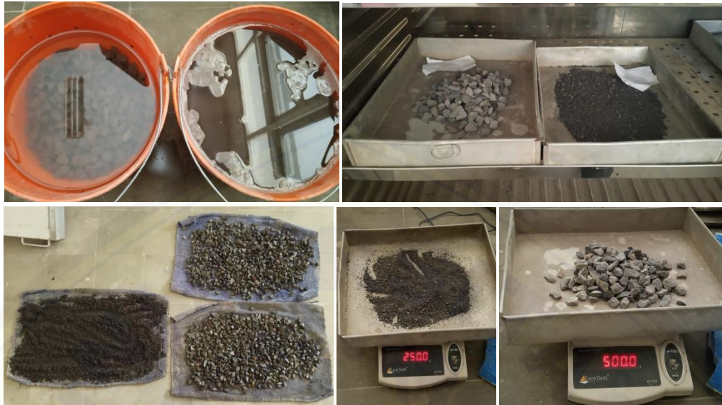
Gambar 15. Pengujian Air Resapan Agregat Kasar dan Agregat Halus
