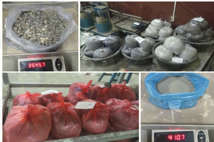
Gambar 10. Penimbangan Kebutuhan Bahan (Semen, Pasir, Kerikil, Lusi, dan Fly Ash )
