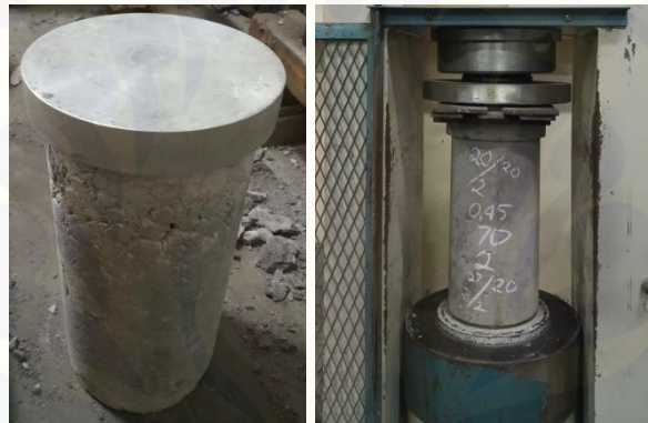
Gambar 30. Pemberian Capping Pada Benda Uji Agar Permukaan Menjadi Rata
