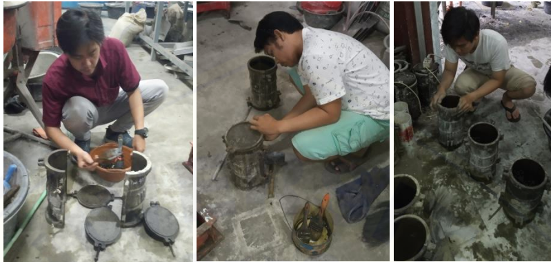
Gambar 21. Persiapan Cetakan Silinder atau Bekisting
