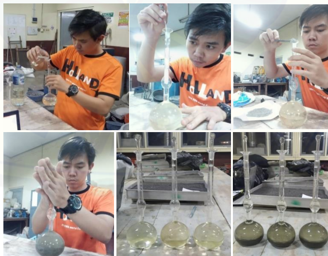
Gambar 11. Pengujian Berat Jenis (Semen, Lusi, dan Fly Ash )
