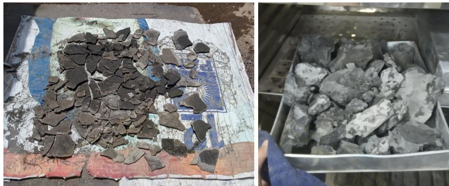
Gambar 4. Pengeringan Limbah Lumpur Sidoarjo Dengan Oven Setelah Kering Oleh Sinar Matahari
