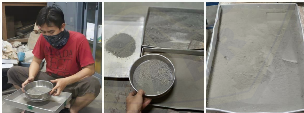
Gambar 6. Penyaringan Limbah Lumpur Sidoarjo Setelah Dihancurkan Menggunakan Ayakan No. 200
