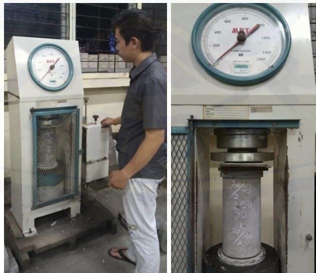
Gambar 31. Pengujian Kuat Tekan Pada Benda Uji
