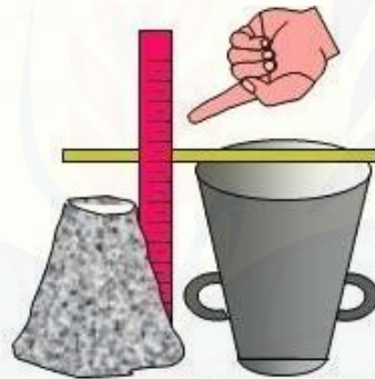
Gambar 2.8 Pengujian Slump atau Slump Test . (Sumber : Ilmutekniksipil.com)
