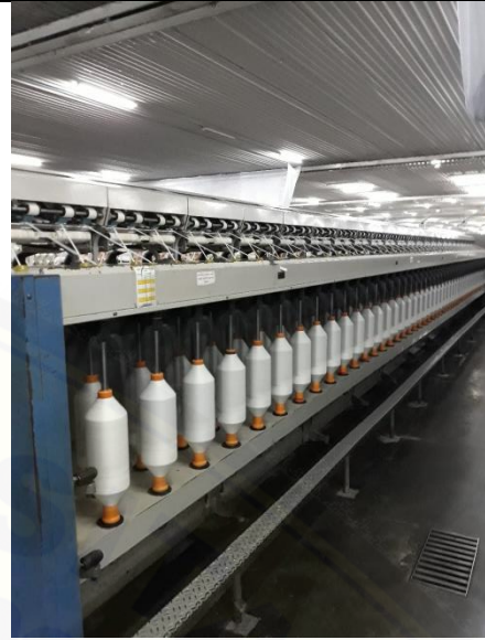
Gambar 10. Mesin ring spinning mentwist benang dari bobin ke tempat gulungan/cop
