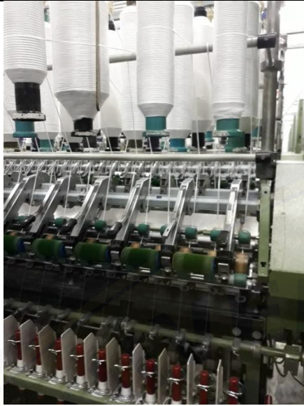
Gambar 9. Mesin simplex sedang menggulung hasilnya ke bobin-bobin
