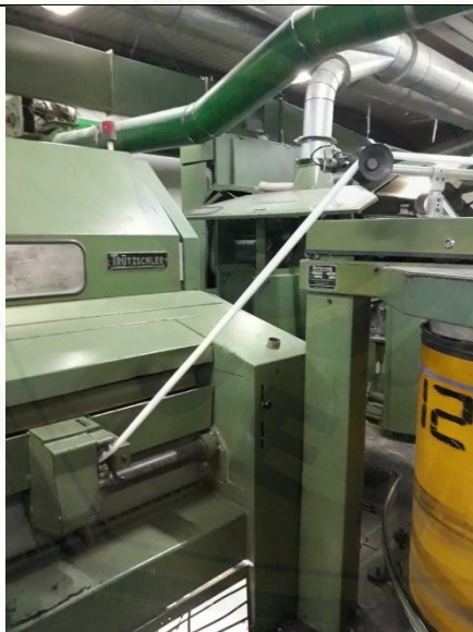
Gambar 3. Proses drafting pada mesin carding
