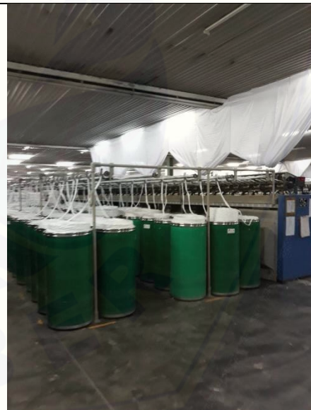
Gambar 8. Proses pada mesin simplex (sliver ditwist (diplintir) menjadi lebih kecil) ke bobin
