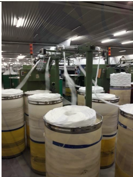
Gambar 7. Sliver ditarik untuk diproses ke mesin simplex
