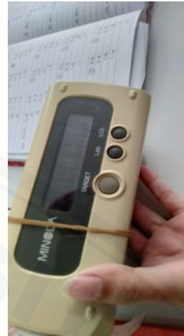
Pengujian derajat putih menggunakan color reader .
