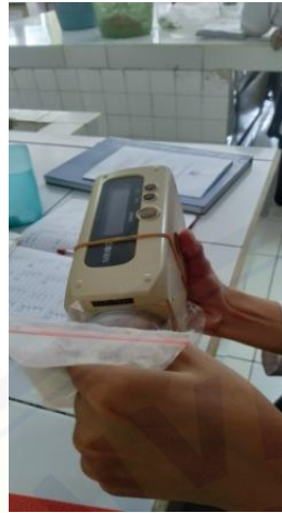
Pengujian derajat putih menggunakan color reader .
