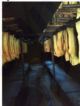
Gambar 17. Proses pengasapan sheet
