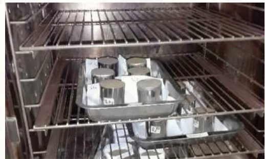
Proses pengovenan ring sampel selama 12 jam
