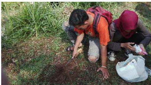
Pengambilan sampel tanah tak terusik pada Sub DAS Arjasa
