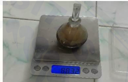
Menimbang picnometer + tanah + air
