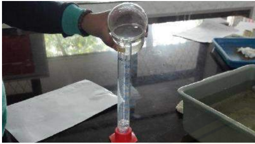
Setelah 1 jam pengujian, hasil lolosnya air diukur menggunakan gelas ukur
