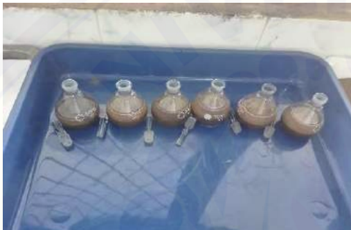
Menimbang picnometer + tanah
