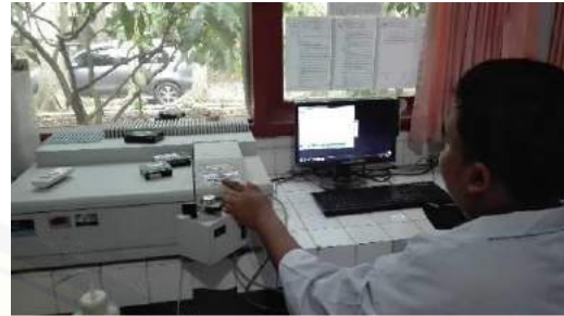
Mengukur absorpsi larutan jernih dengan spektrofometer
