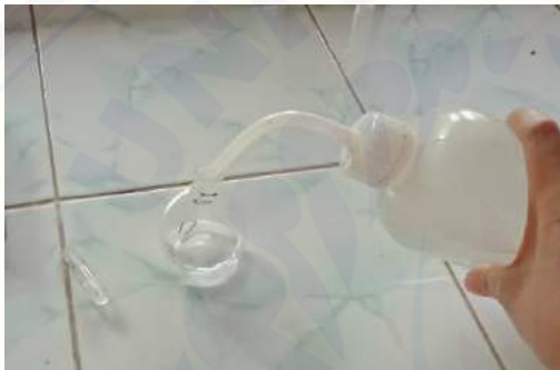
Mengisi pycnometer dengan air
