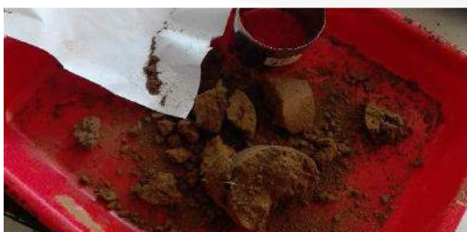
Membersihkan ring dari tanah
