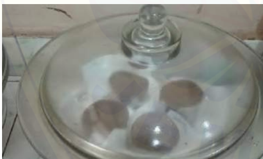
Memasukkan sampel ke eksikator, setelah di oven
