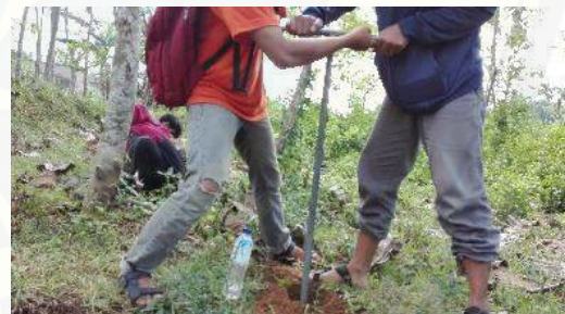
Pengambilan sampel tanah terusik pada Sub DAS Arjasa
