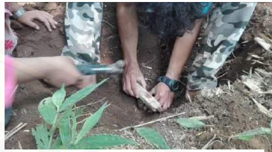
Pengambilan sampel tanah tak terusik pada Sub DAS Arjasa
