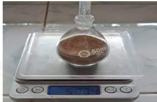
Menimbang picnometer + tanah
