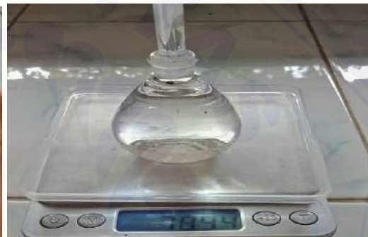
Mengisi pycnometer dengan air
