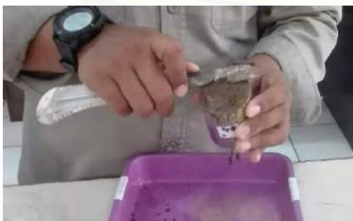
Meratakan permukaan tanah di ring
