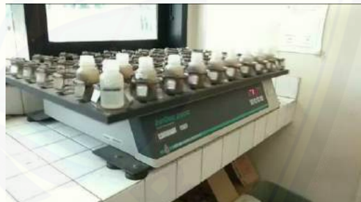
Mengocok sampel selama 30 menit menggunakan mesin pengocok
