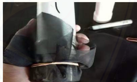
Memasang kain saring, supaya tanah tidak jatuh ke bawah
