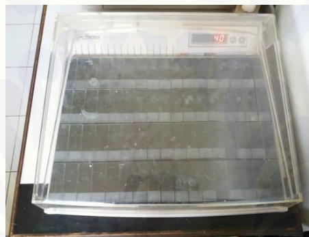
Slide preparat disimpan dalam Slide warmer sebelum dilakukan pewarnaan
