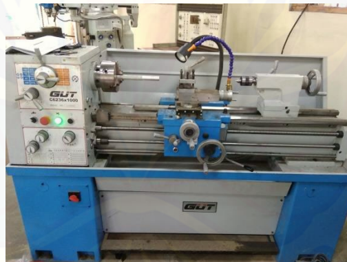
Gambar 3.1 Mesin bubut tipe GUT C6236x1000
