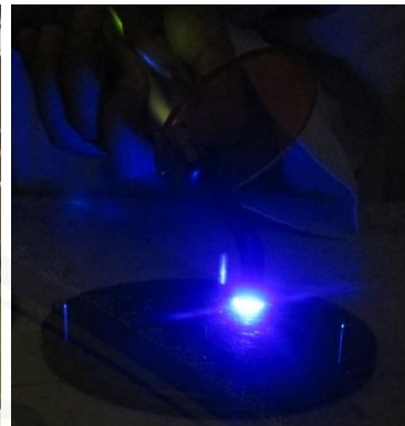
Polimerisasi menggunakan LED curing unit selama 10 detik
