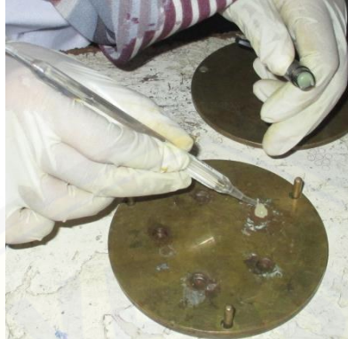
Mengaplikasikan komposit hingga ketebalan 4,2 mm
