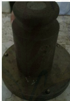
Meletakkan beban 1 kg di atas tutup cetakan
