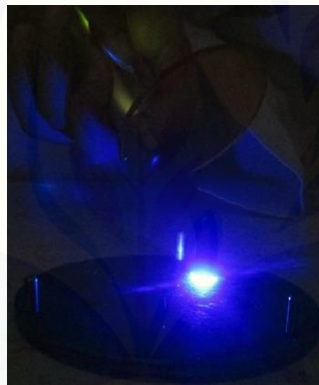
Polimerisasi menggunakan LED curing unit selama 10 detik
