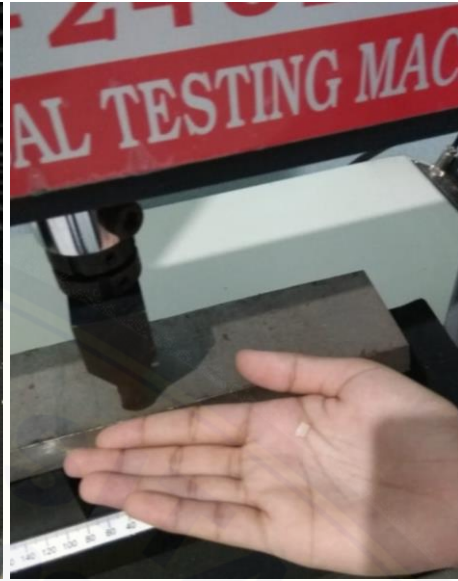
Sampel pecah setelah penekanan
