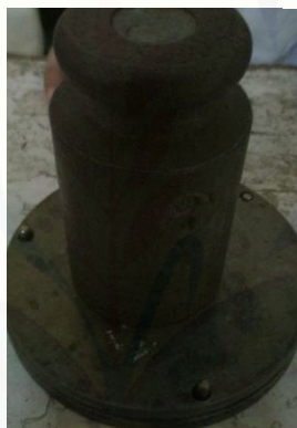
Meletakkan beban 1 kg di atas tutup cetakan
