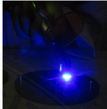
Polimerisasi menggunakan LED curing unit selama 10 detik
