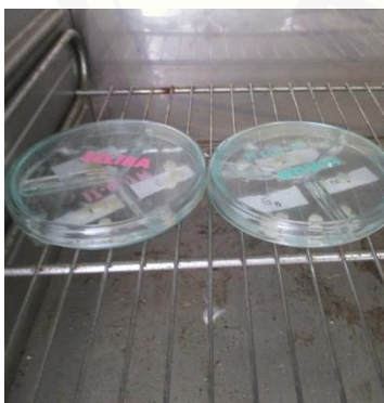
Direndam dalam aquadest steril dan dimasukkan inkubator 37°C selama 24 jam
