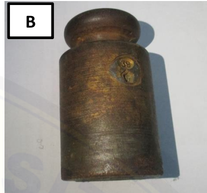
(A) Cetakan model kuningan (B) Anak timbangan 1 kilogram
