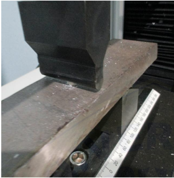
Penekanan dilakukan hingga sampel pecah dan tekanan dihentikan
