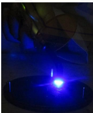
Polimerisasi menggunakan LED curing unit selama 10 detik
