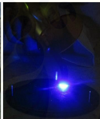
Polimerisasi menggunakan LED curing unit selama 10 detik
