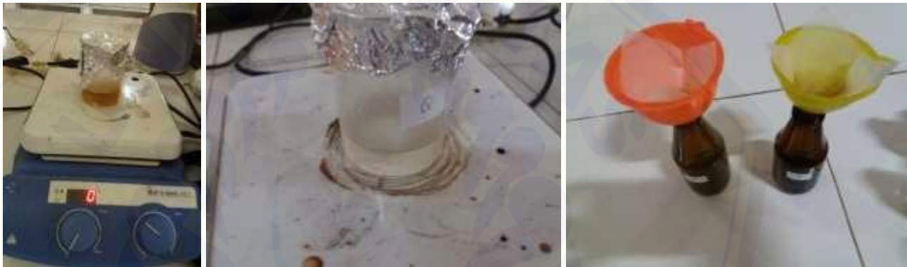
Proses Ekstraksi Kopi dan Ekstraksi Kafein dari Ekstrak Kopi
