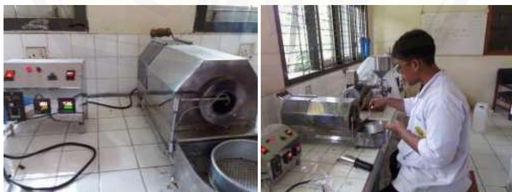
Setting Suhu dan Lama Waktu Pada Alat Penyangrai serta Proses Penyangraian
