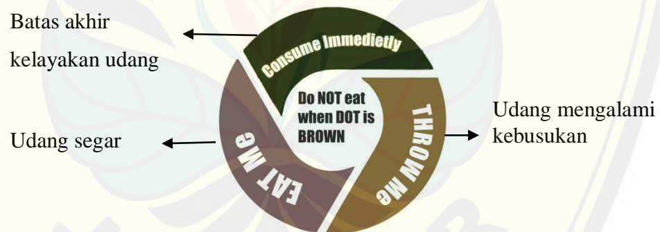
Gambar 3.2 Desain sensor kesegaran
