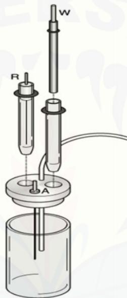
Gambar 2.1 Sel elektrokimia voltametri
