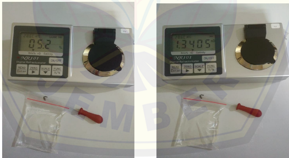
Gambar C1. Pengambilan Data Menggunakan Refraktometer Digital a. Kadar Gula 35% dan b. Indeks Bias pada Konsentrasi 35%
