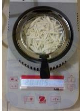
Gambar 3.2 Penempatan bahan ke sample fan OHAUS MB25
