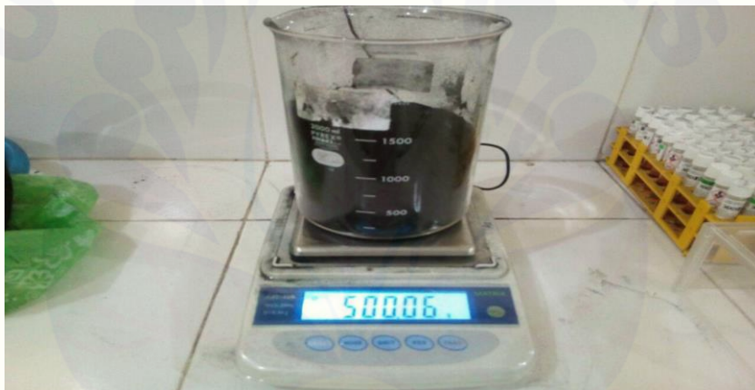
Gambar A 2. Penimbangan karbon aktif sebelum adsorpsi
