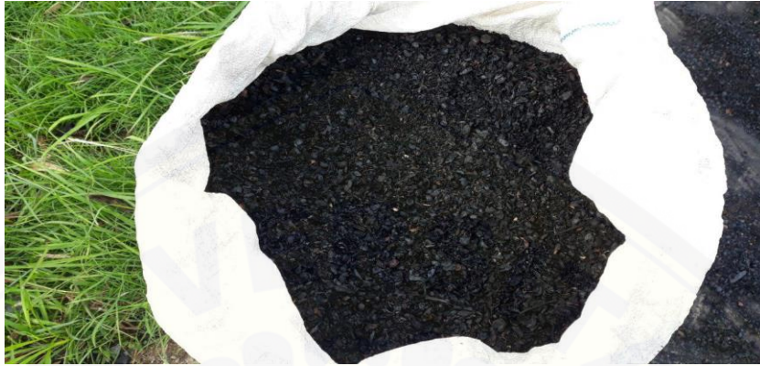
Gambar A 1. Karbon aktif setelah proses karbonasi
