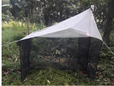
Gambar 2.19 Pengambilan serangga parasitoid menggunakan perangkap malaise
