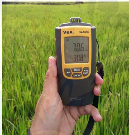
Gambar 3.3 Pengukuran suhu dan kelembapan menggunakan THM
