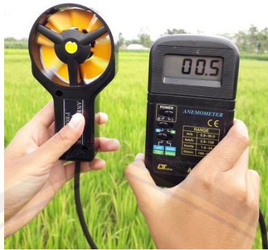
Gambar 3.4 Pengukuran kecepatan angin menggunakan anemometer
