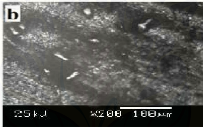
Gambar 2.19 Hasil pengujian Scanning Electron Microscopy (SEM) pada Al6061 + 4% Cu + 5% SiC (Haque dkk., 2014).
