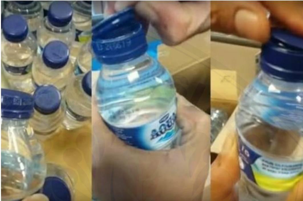
Gambar air minum merk Aqua 330ml yang tutup botolnya mengalami cacat kemasan (Rusak).
