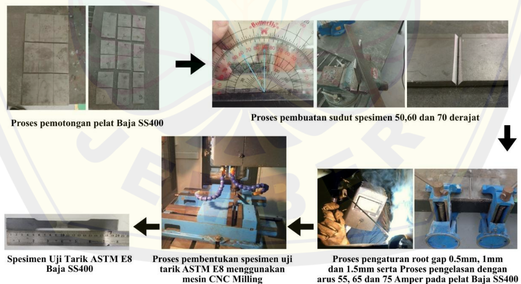
Gambar 4.1 Proses manufaktur pembuatan spesimen ASTM E8
