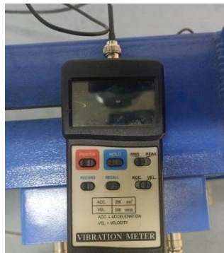
Gambar 3. 1 Pengambilan Data dengan Vibration Meter
