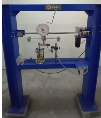
Gambar 2. 2 Vibration Simulator Sumber : Laboratorium Perancangan Mekanik)
