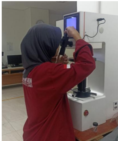
Gambar 4.11 Kampas Rem di uji Kekerasan
