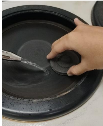
Gambar 4.10 Kampas Rem diampelas
