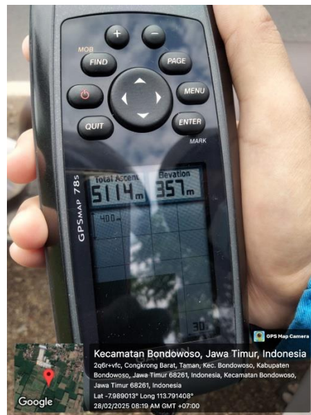
Gambar 4.6 Pengukuran Elevasi menggunakan GPS Garmin 78s
