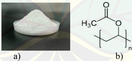
Gambar 2. 3 a) Polivinil alkohol (PVA), b) struktur rantai PVA (Alhulaybi & Dubdub, 2024)
