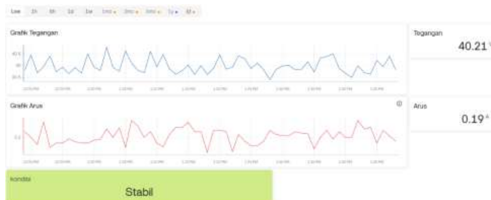
Gambar 4.9 Tampilan Grafik Tegangan dan Arus serta Kondisi dari Sistem SMPS pada Aplikasi Blynk
