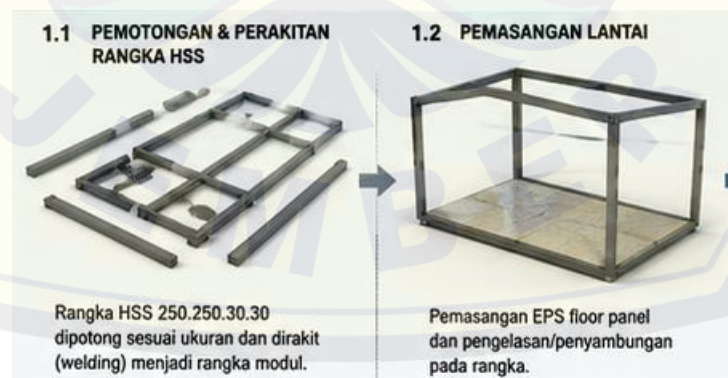
Gambar 4.4 Alur Prefabrikasi Modular
