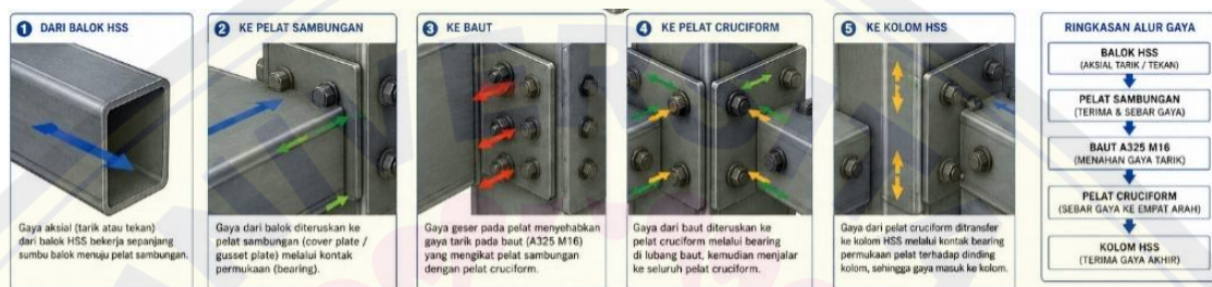
Gambar 4.28 Jalur Transfer Gaya Sambungan
