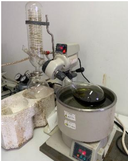
e. Proses pemekatan ekstrak dengan rotary evaporator
