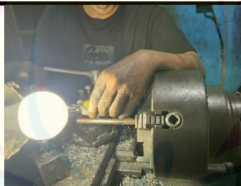
Menguji kesejajaran logam dengan dial indicator
