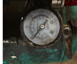
Mengatur tekanan pneumatik sebesar 4 bar
