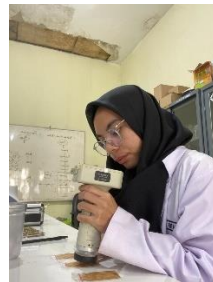
Pengukuran warna dengan color reader
