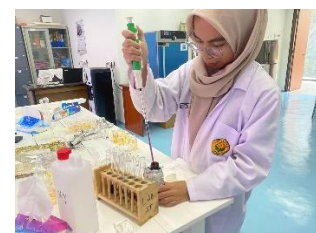
Pengujian aktivitas antioksidan dengan DPPH
