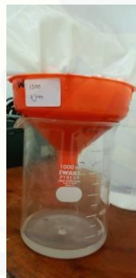
3. Memasukkan abu, ditambah HCL 0.1 M 150 ml, diaduk dengan stirrer magnetic 1 jam, didiamkan suhu ruang 24 jam, lalu disaring
