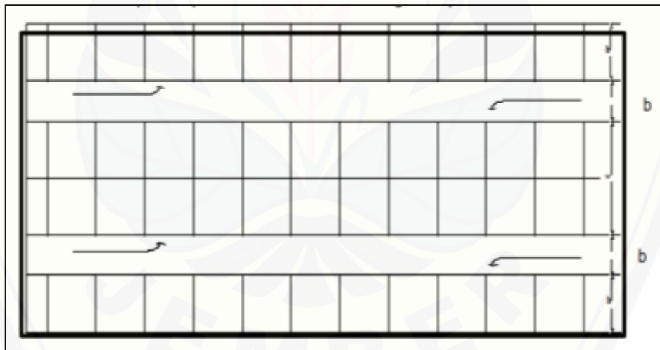
Gambar 2.25 Desain Parkir Pulau Sepeda Motor
