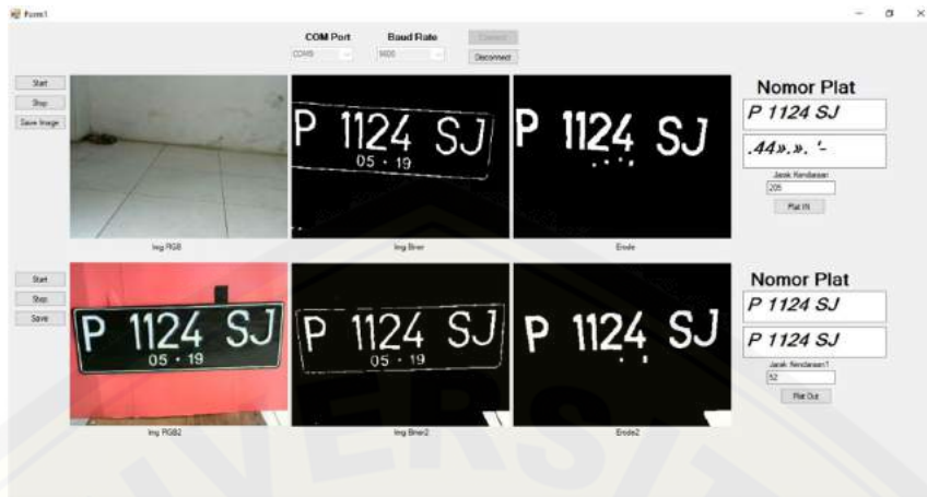
Gambar 3.29 Proses Metode OCR Pada Citra Image 2 Dengan Hasil P 1124 SJ
