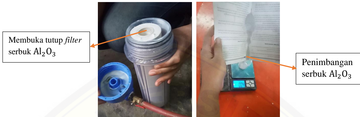
Gambar 3.8 Proses pembukaan saringan nano dan kolektif serbuk \text{Al}_2\text{O}_3
