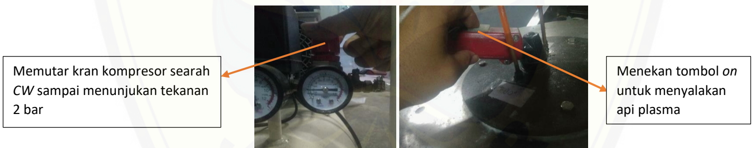
Gambar 3.3 membuka kran kompresor dan obor plasma
