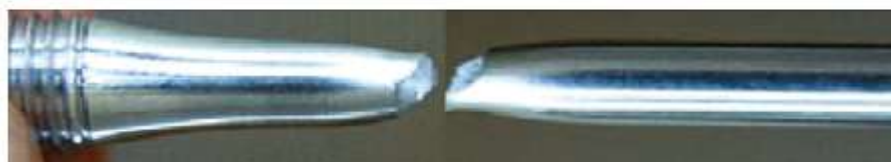
Gambar 2.10 Sampel uji tarik dari bahan Aluminium setelah pengujian Tarik (Bryson, 2015).
