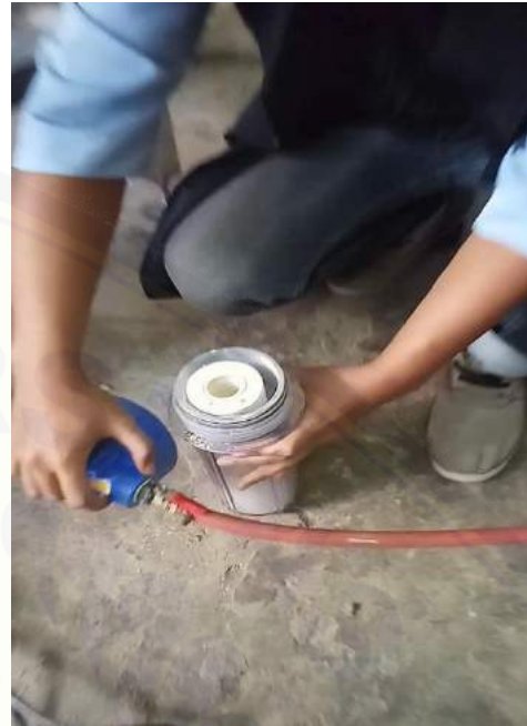
Gambar Proses pembongkaran Filter
