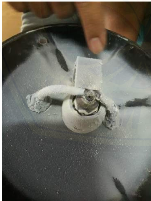
Gambar serbuk nanopartikel alumina pada piringan nozzle plasma
