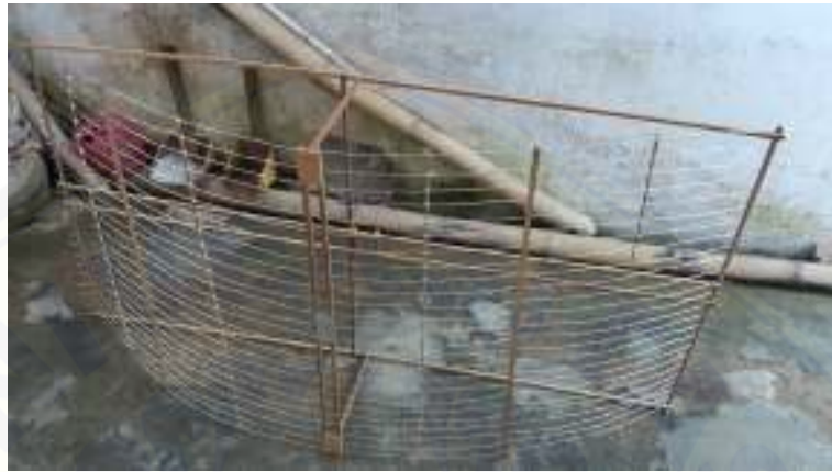
Gambar 4.14 Hasil Fabrikasi Reflektor Parabolic Silinder 3.5cm
