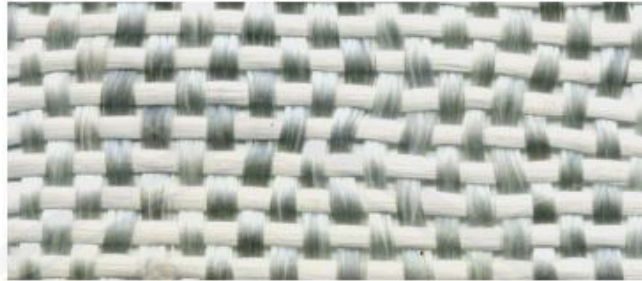
Gambar 2. 10 Susunan serat gelas woven roving (Carli dkk., 2012)
