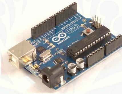
Gambar 2.6 Modul Kontroler Arduino
